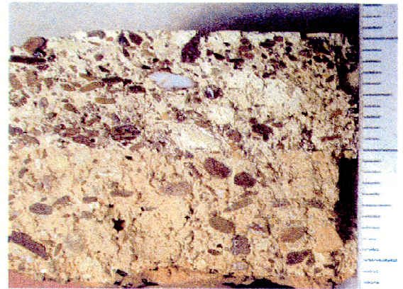
Abb: M-13, Ahrweiler, Raum 5, Korridor, Ansicht des Mörtelaufbaus im Querbruch.
