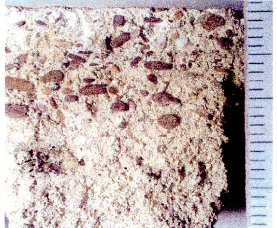
Abb: M-10, Ahrweiler, Römervilla, Raum 2/2, Opferdienerwand, Ansicht des Mörtelaufbaus im Querbruch.
