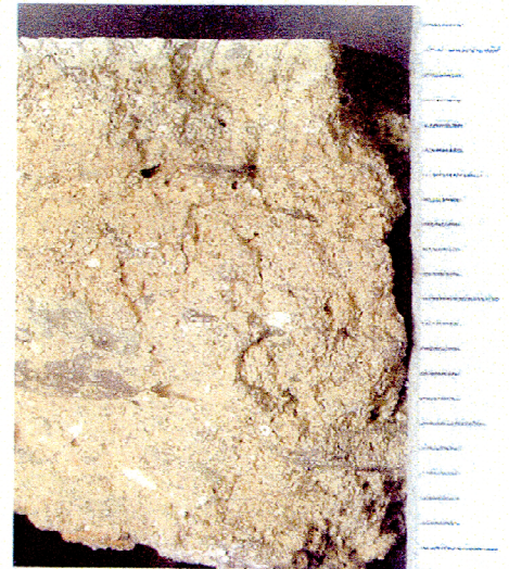
Abb: M-11, Trier, Gilbertstrasse, Apollozimmer, Ansicht des Mörtelaufbaus der Deckenmalerei im Querbruch.
