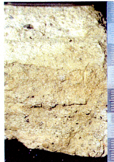
Abb: M-17, Grenzach, Steingasse, Ansicht des Mörtelaufbaus im Querbruch.
