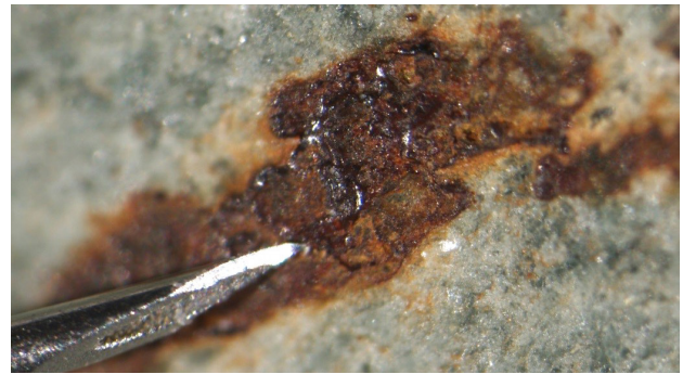
Abb. 2: Detail-Aufnahme; Ausbluten der roten Schicht und Glanzeffekt der dünnen Eisenkruste [Pristl 2018].
