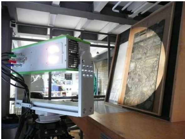
Abbildung 3: 3D-Scanner Comet VarioZoom der Fa. Steinbichler Optotechnik GmbH beim Scannen in der Glaswerkstatt des Erfurter Doms.
