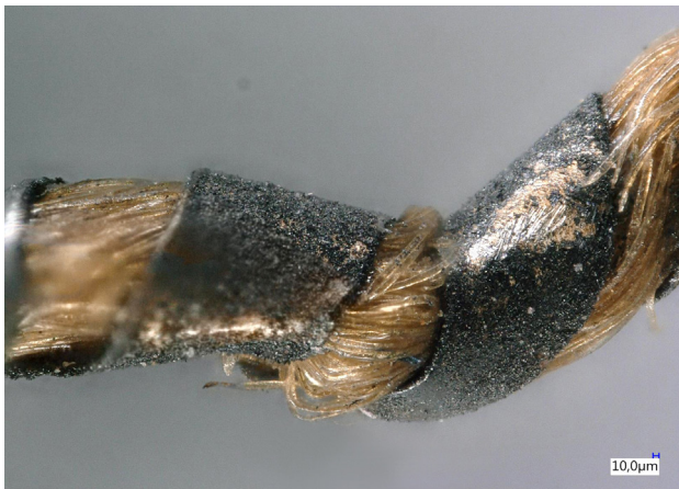
Abb. 1: Fasermikroskopaufnahme Probe K01; Unter der schwarzen Schicht erscheint eine goldfarbene Oberfläche mit Bearbeitungsspuren [Pristl 2018].
