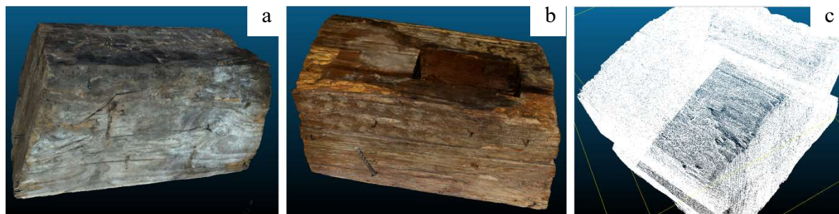
Abb. 3: Aufnahmeergebnisse aus aktiven Messverfahren: a – Hexagon Strifenlicht-Scanner; b – Creaform structured light scanner; c – Lichtschnittverfahren mit Hexagon Messarm.
