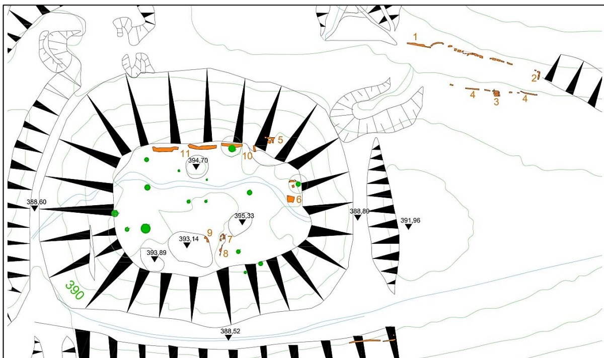
11 Baubefunde (orange) und Baumkataster mit maßstabsgerechter Darstellung der Stammdurchmesser (grün). Hauptburg und westlicher Bereich der Ostterrasse.
