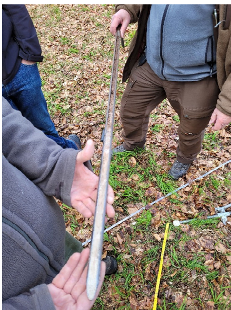
39 Bohrstock mit Bohrkern, April 2023.
