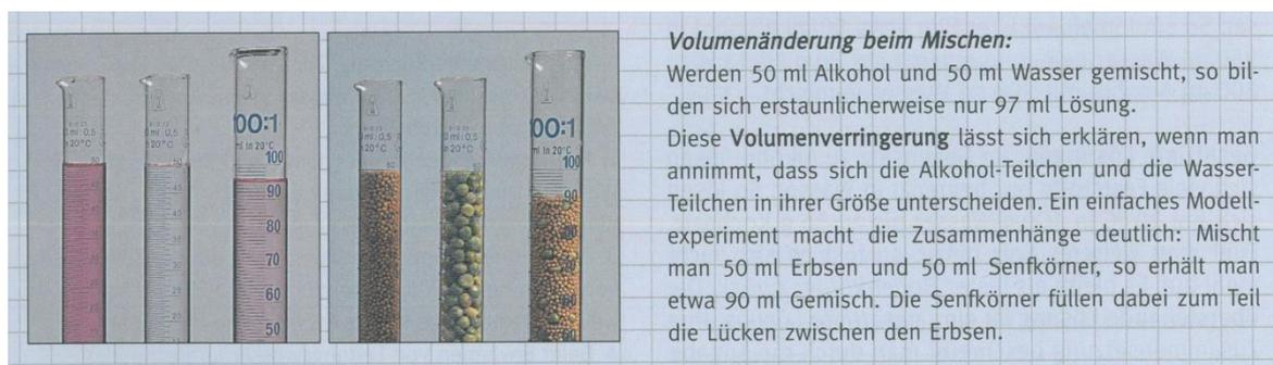
Abb. 14: Versuch zur Volumenkontraktion
