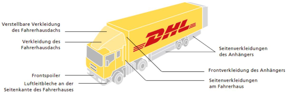
Abbildung 13: Senkung des Kraftstoffverbrauchs durch Luftwiderstandsreduktion<sup>69</sup>
