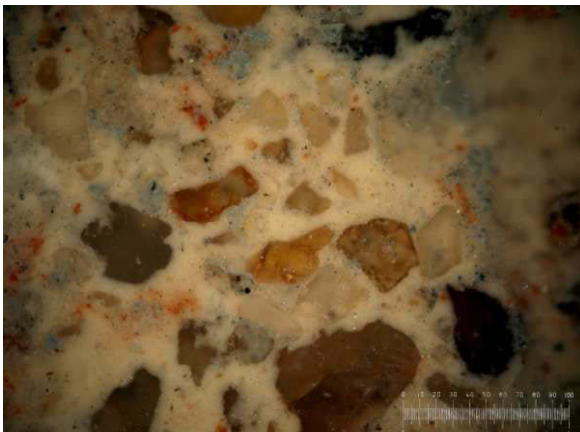
Abb.17.168: Anschliff der Putzhaut der Ostfassade Probe M.11 (Auflicht).
