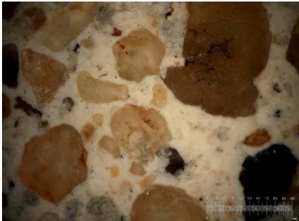
Abb.17.156: Anschliff des Barockmörtels Probe M.05 (Auflicht).
