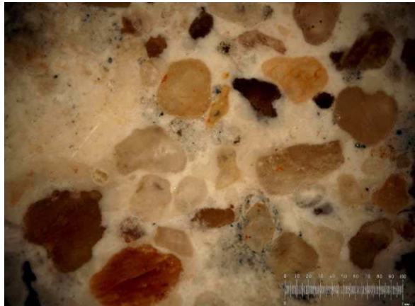
Abb.17.162: Anschliff des Barockmörtels Probe M.07 (Auflicht).
