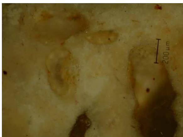
Abb.17.146: Anschliff des Grobputzes Probe M.15 (Auflicht).
