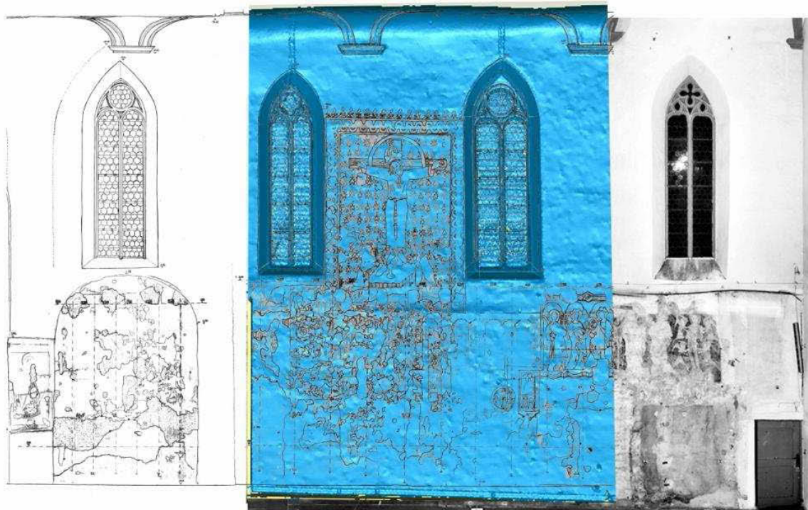
Abb.17.172: Montage aus dem verformungsgerechtem Aufmaß, dem 3-D-Scan (blau) und der orthogonalen Messbildaufnahme.
