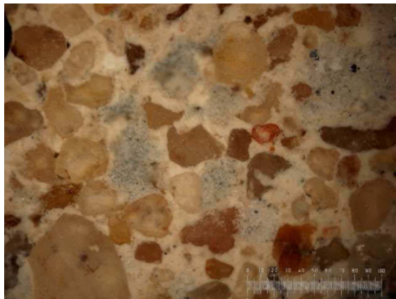
Abb.17.158: Anschliff des Barockmörtels Probe M.06 (Auflicht).
