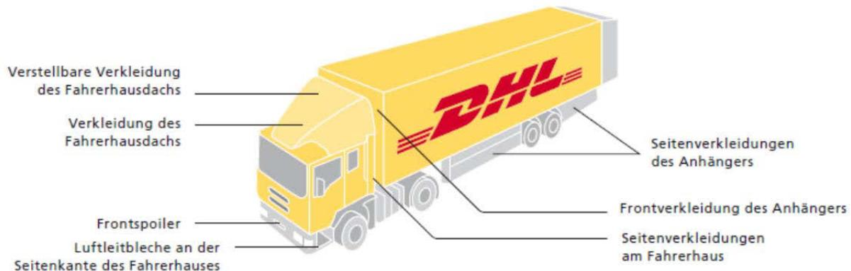
Figure 4: Senkung des Kraftstoffverbrauchs durch Reduktion des Luftwiderstands<sup>16</sup>
