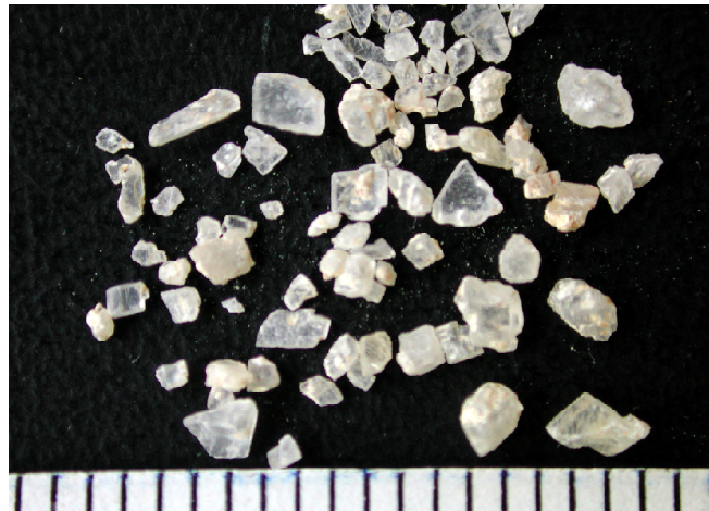
Abb. 11, Xanten, Insula 19, Adler-Gigantenwand, gereinigter Calcitgries aus dem Oberputz.
