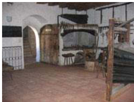
Abb. 5.88 Werkstatt mit Amboss, Feuerzangen, Esse und Blasebalg eines Huf- und Wagenschmieds
