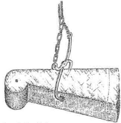
Versatz mit der Steinzange
