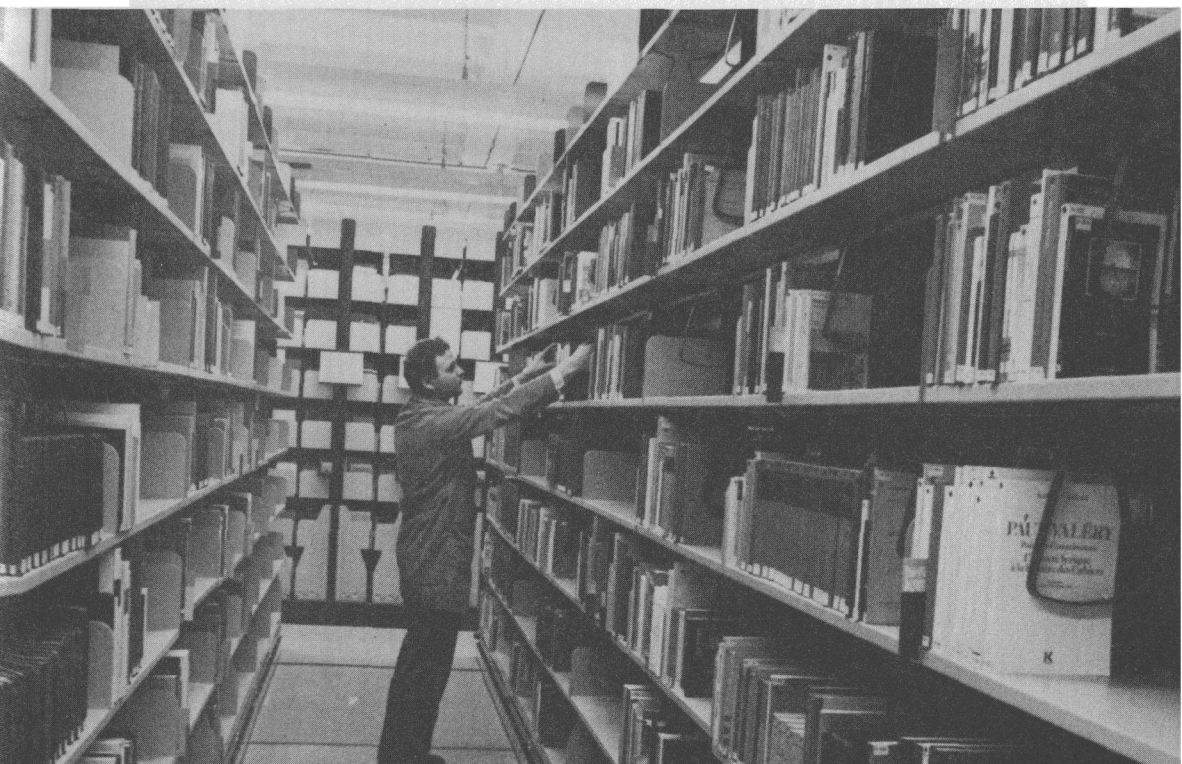
Abb. 10 Kompaktregalanlage mit Elektroantrieb. Regalhöhe 2,81 m; Regaltiefen 535 mm (für Großformate 655 mm und 835 mm)
