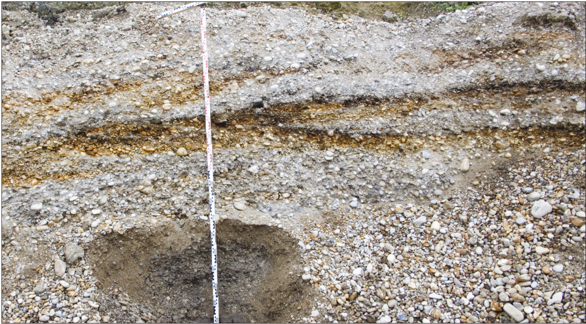
Bild 4: Großbogig schräggeschichteter qhj2-Wertachschotter in der Kiesgrube „Gnadental“ (A4) (Foto: G. SCHELLMANN Sept: 2015).
