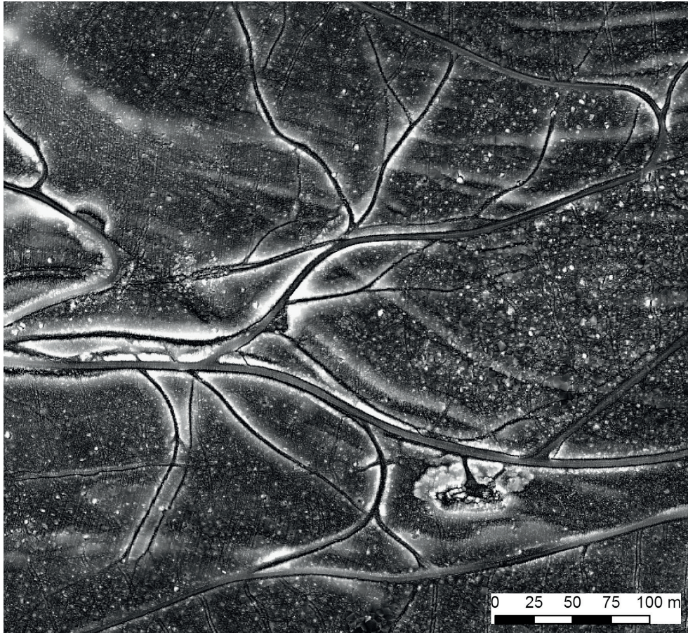
22 Negative Openness. Aufgelassene und modern genutzte Wege zeichnen sich deutlich als hell umrahmte, schwarze Linien ab.
