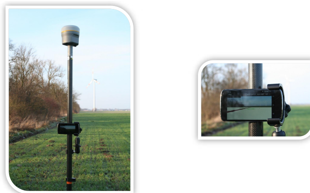
Abbildung 7.19: Gekoppelte GeoARS mit Verwendung eines präzisen GNSS-Empfängers (hier: geodätischer Empfänger Trimble R10)
