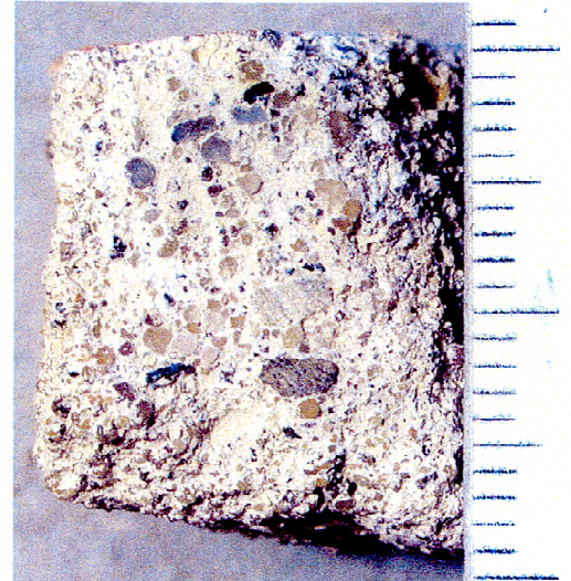
Abb: M-3, Xanten, Insula 19 Ost, Kompartiment 59, Ansicht des Mörtelaufbaus im Querbruch, Unterputz weitgehend verloren.
