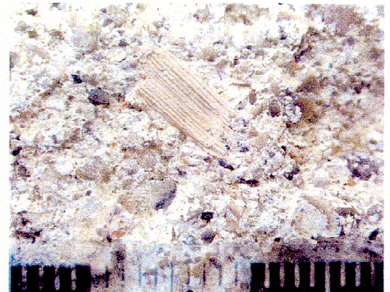
Abb: M1.2-1, Schwangau, Wandmalerei, Ansicht im Querbruch mit Abdrücken von organischen Fasern im Oberputz.
