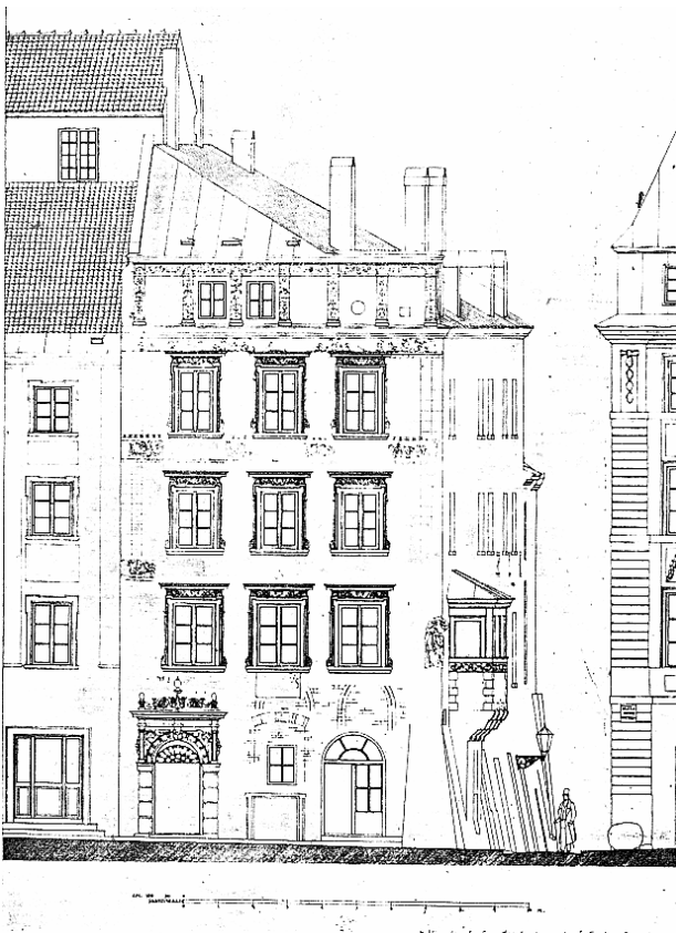
Abb. 263. Rynek Nr. 31. Marktfassade während der Restaurierung in den Jahren 1913-1915. Auf dem Bild sind die während der Restaurierungsarbeiten freigelegte Fragmente der Sgraffito sichtbar. Zeichnung T. Sawicki J. Wojciechowski (Leitung). Nach: Baruch Maksymilian/Wojciechowski Jarosław, Kamienica Książąt Mazowieckich (Das Haus der Herzöge von Masowien) , Warszawa 1928, Fig. 8.
