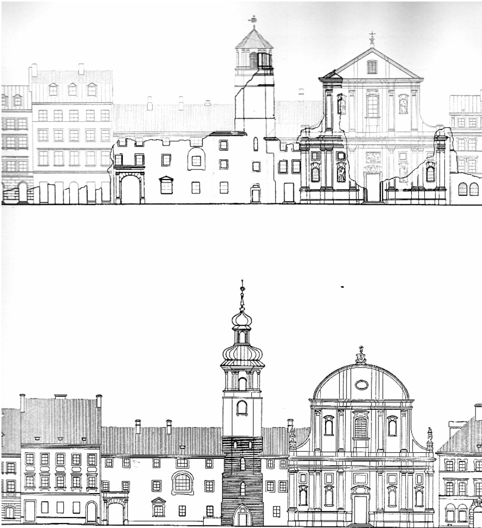
Abb. 164. Fragment der Ansicht der Piwna-Straße mit der Kirche St. Martin und dem Augustinerkloster. Oben Zustand vor 1945, unten Entwurf für Wiederaufbau.
