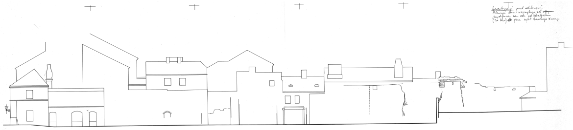
Abb. 68. Entwurf für die Freilegung der Wehrmauer in 1936. Die Innenmauer, gesehen von der Seite der Zwischenmauer (1:100). Abschnitt von Nowomiejska-Straße bis Szeroki Dunaj-Straße. Zeichnung Jan Zachwatowicz. ZAP PW 16687
