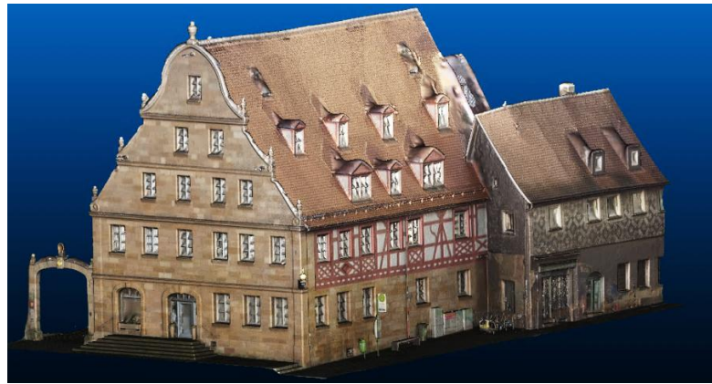
Abbildung 56: Das generierte Mesh mit Texturen und RGB-Farben in CC
