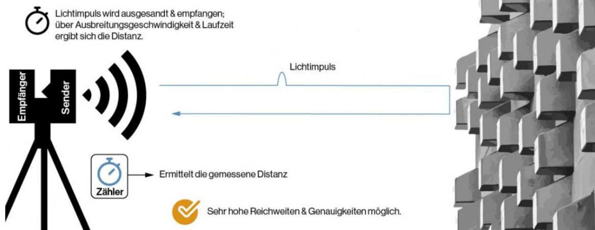
Abbildung 17: Impulslaufzeitverfahren, Messverfahren von Leica BLK 360; Bild von: https://www.laserscanning-europe.com/de/unsere-leistungenhardware/terrestrische-laserscanner
