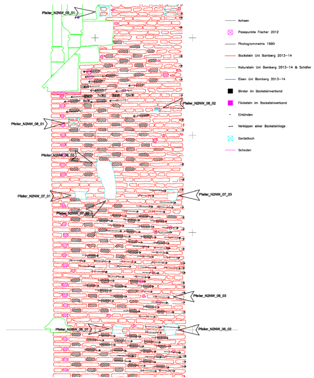
7 Ulm, Münster, Chor, Pfeiler N2. Abwicklung mit Umzeichnung des Backsteinmauerwerks, zusätzlich Markierung der Binder, Flickstücke und Neigungen (Ausschnitt).
