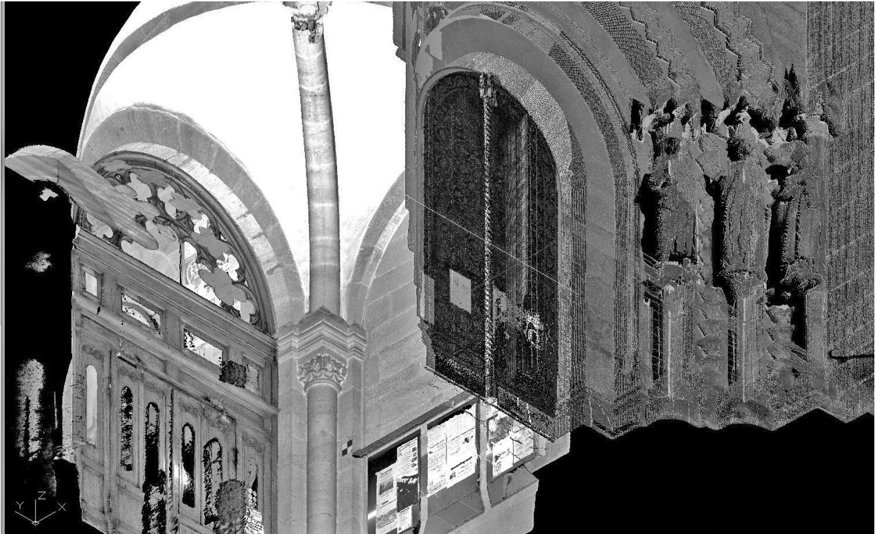
3 Bamberg, Dom, Turm Südost. Isometrische Darstellung der 3D-Punktwolke des EG von Südosten. Die Punktwolken der äußeren und inneren Oberflächen sind gleichzeitig dargestellt.
