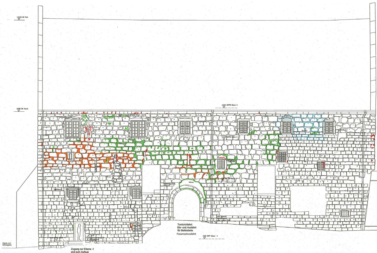
13 Veste Heldburg, Heidenbau, Ansicht von Nordosten (ohne Maßstab). Restauratorische Dokumentation von Farbbefunden auf den Fugenmörteln und Quaderflächen (Jürgen Scholz).
