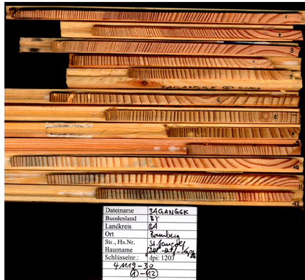
7 Probenscan mit 1200 dpi Auflösung. Dauerhafte Beschriftung der Probennummern. Bohrkerne (8 mm) auf Holzträger aufgeleimt.
