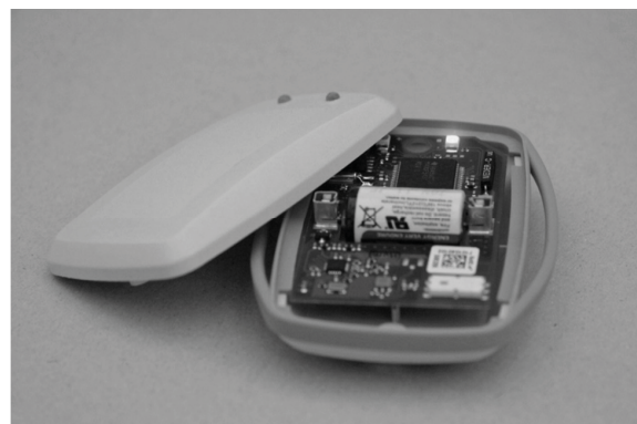
Abb. 5: Messgerät, welches im Rahmen des Supply Chain Event Managements für das innerbetriebliche Asset Management durch einen s-net Sensorknoten des Fraunhofer IIS überwacht wird
