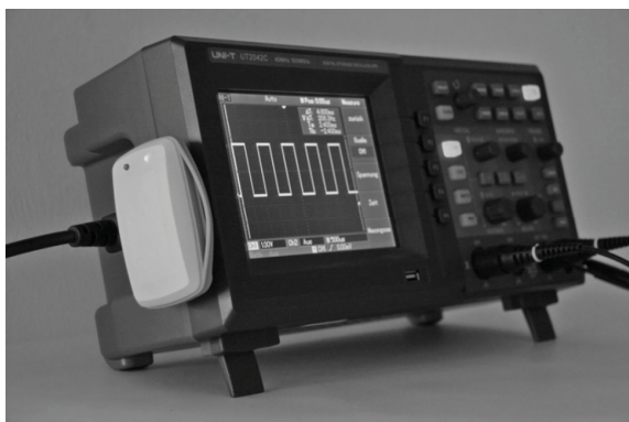
Abb. 5: Messgerät, welches im Rahmen des Supply Chain Event Managements für das innerbetriebliche Asset Management durch einen s-net Sensorknoten des Fraunhofer IIS überwacht wird
