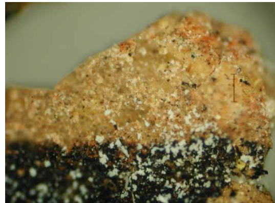
Abb.17.436: Mikroskopische Aufnahme eines Partikels der Metallapplikation mit Resten einer schwarzen Konturierung und aufliegenden Tüncheresten (Auflicht).
