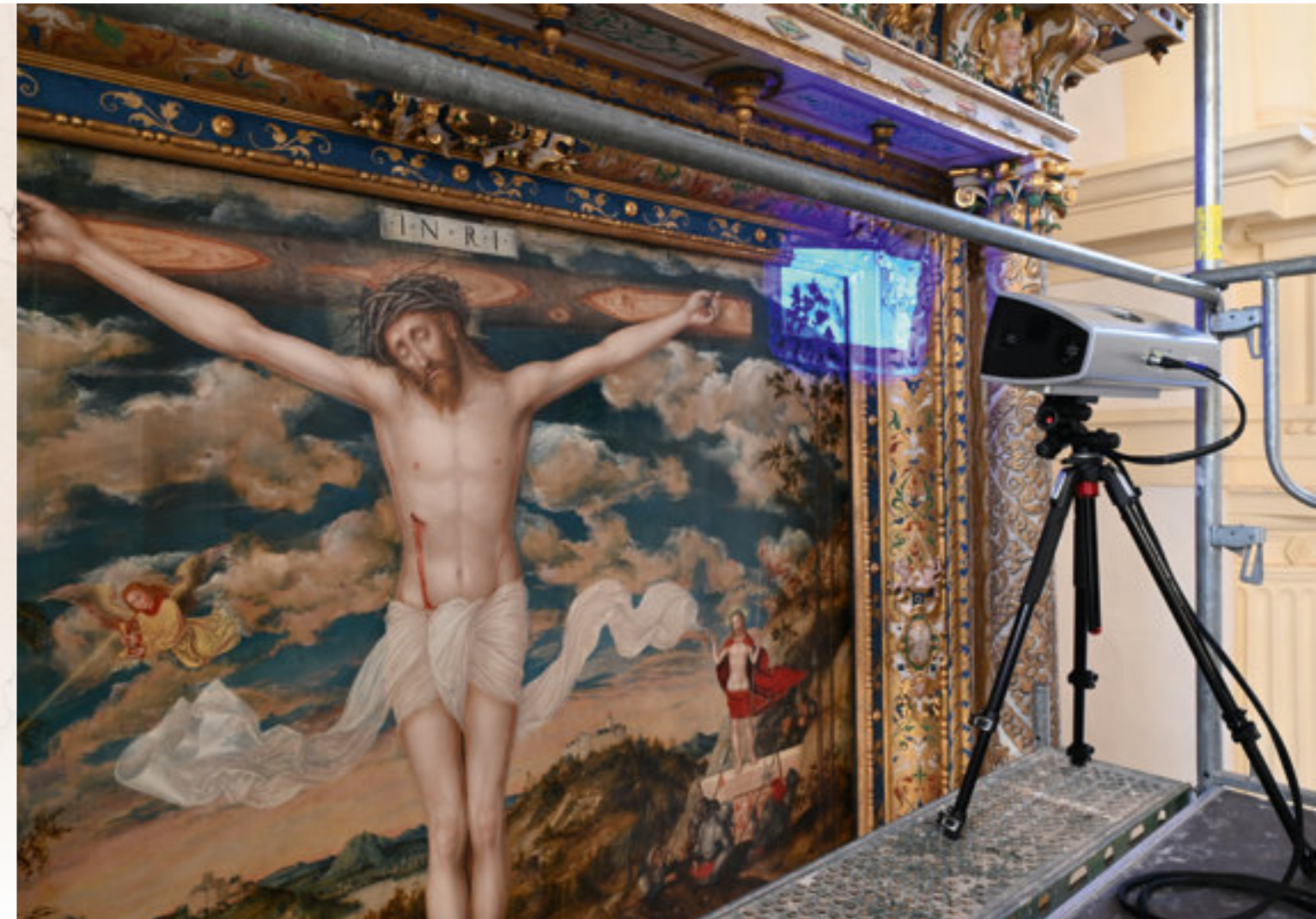
Abbildung 3: 3D-Scanner im Einsatz am Tafelgemälde in Schloss Augustusburg
