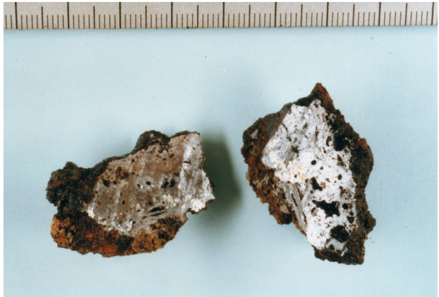
60 Sägeschnitt durch Schlackebröckchen L-1/3d vom Titelberg (Inv. Nr. 1995/70/581-s) mit viel Metall (helle Bereiche).
