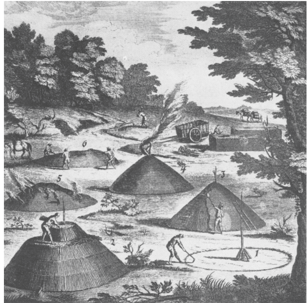
39 Meilerkonstruktionen im 18. Jahrhundert (nach Duhamel du Monceau 1761).
