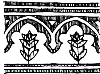
Fig. 25. Konsolenfries an der Transeptfassade
