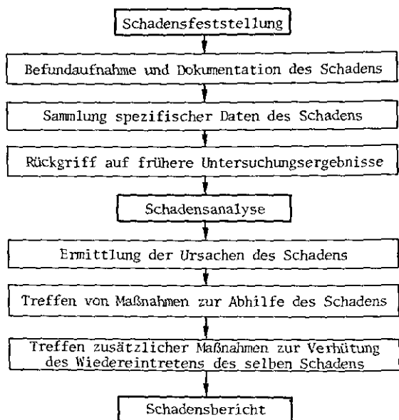
Abb. 4.6: Ablauf von Schadensuntersuchungen
