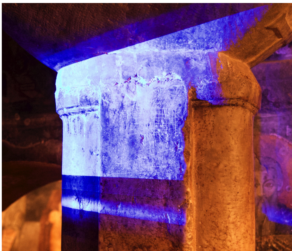
Abb. 10: Berührungsfreies Abtasten mit Meßlicht; rechte Säule, mit ‘Netz’
