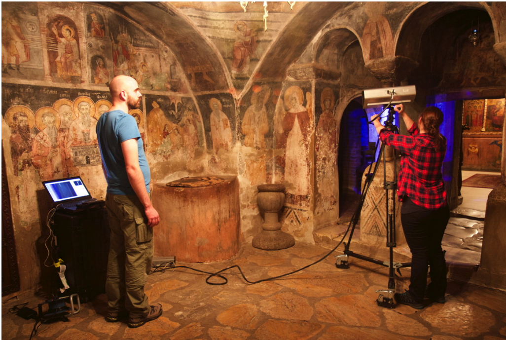
Abb. 11: Scanvorgang mit Scanner auf Stativ und angeschlossenem Laptop zur Steuerung und Datenübertragung
