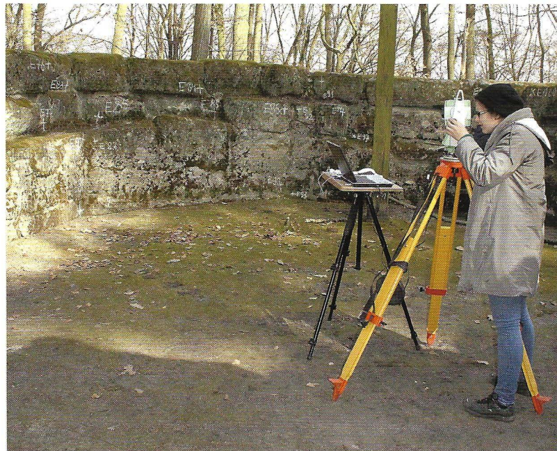
Abb. 1: CAD-gestütztes, tachymetrisches Aufmaß des Innenraums der Helenenkapelle, März 2015
