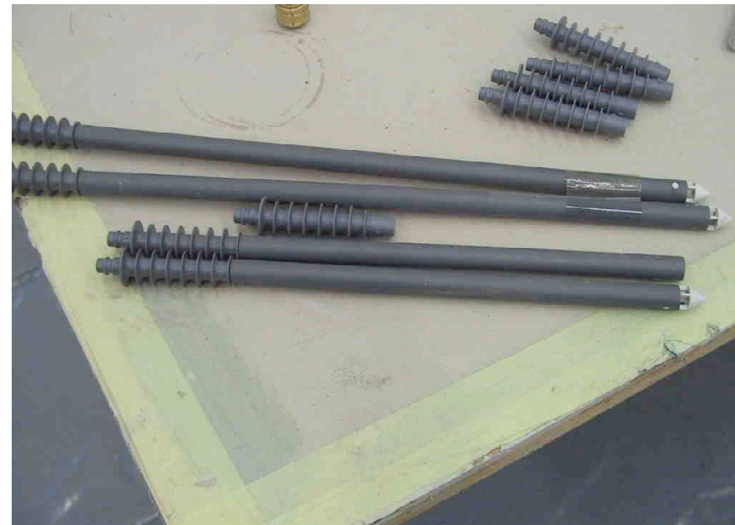
F 434 b Bohrpacker Lehrgang Nov. 2003 Fa. MC Bauchemie Bottrop 2003 S.Thole
