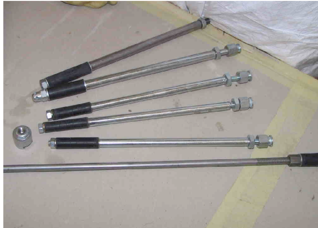
F 434 c Schlagpacker Lehrgang Nov. 2003 Fa. MC Bauchemie Bottrop 2003 S.Thole
