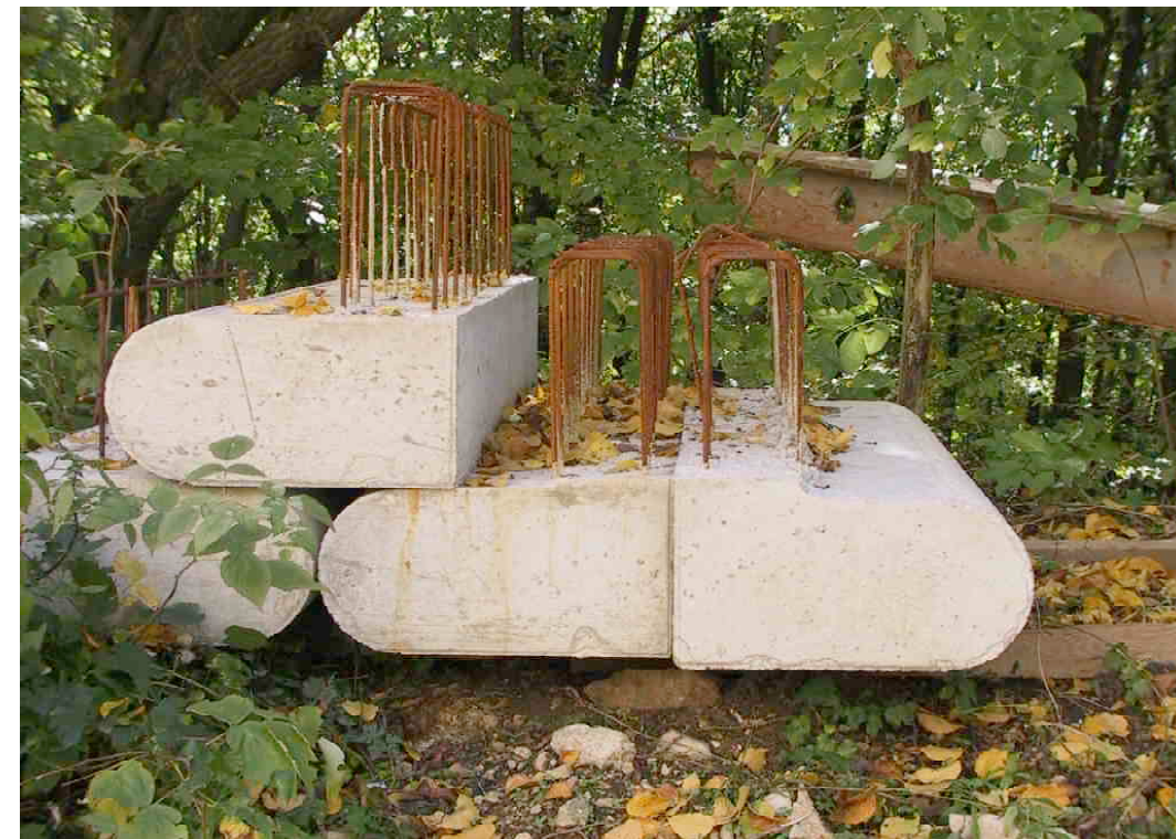
F 332 Betonfertigteile mit Armierung
