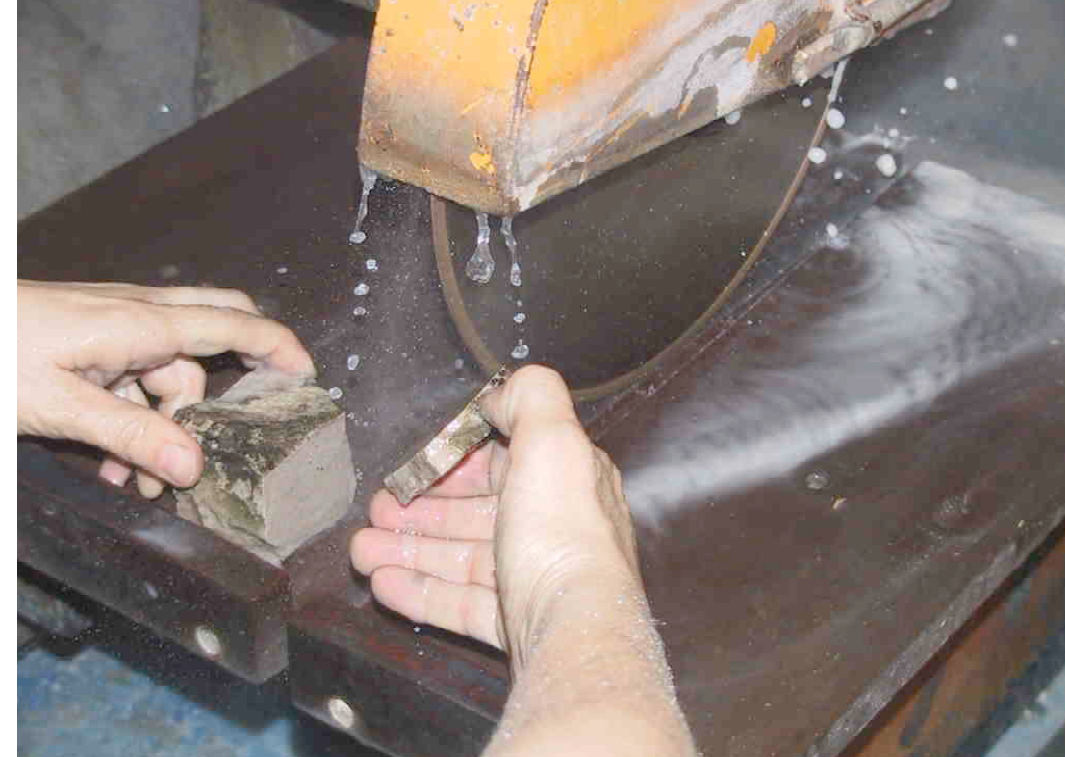
F 462 Steinproben der Südostkurtine Schneiden der Proben 2005 S. Thole
