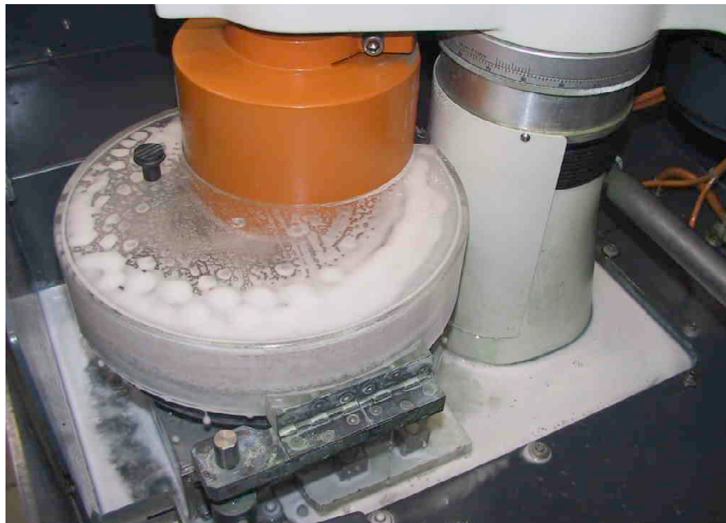
F 463 Steinproben der Südostkurtine Schleifen der Proben 2005 S. Thole
