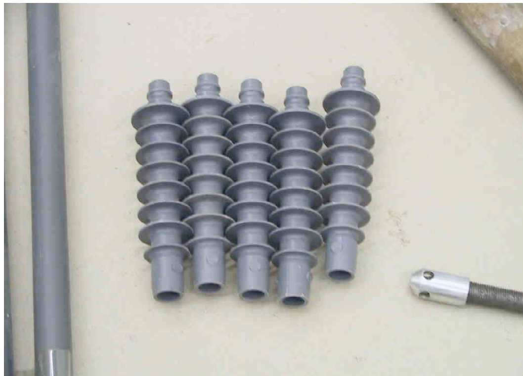
F 434 a Bohrpacker Lehrgang Nov. 2003 Fa. MC Bauchemie Bottrop 2003 S.Thole
