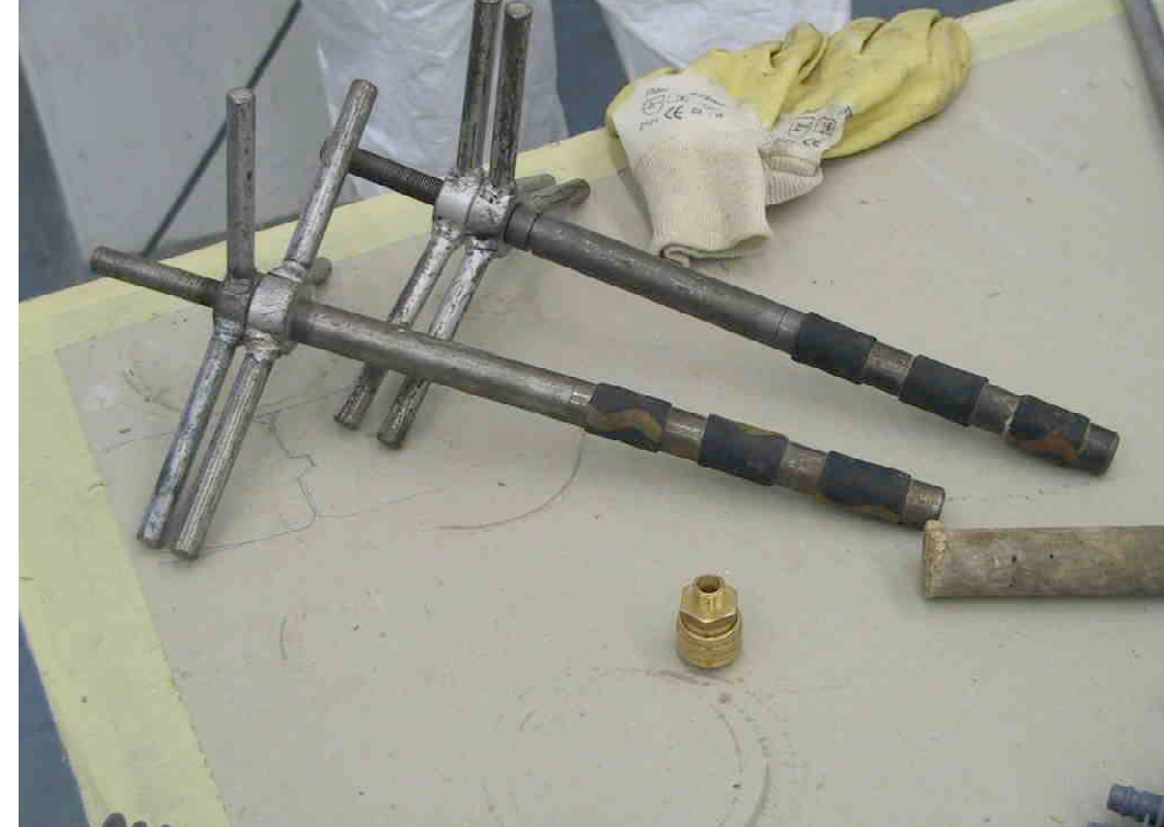
F 434 d Schlagpacker Lehrgang Nov. 2003 Fa. MC Bauchemie Bottrop 2003 S.Thole
