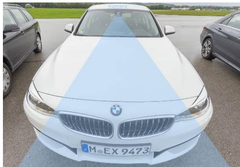
Abbildung 19: Mono-Kamera-System im BMW
