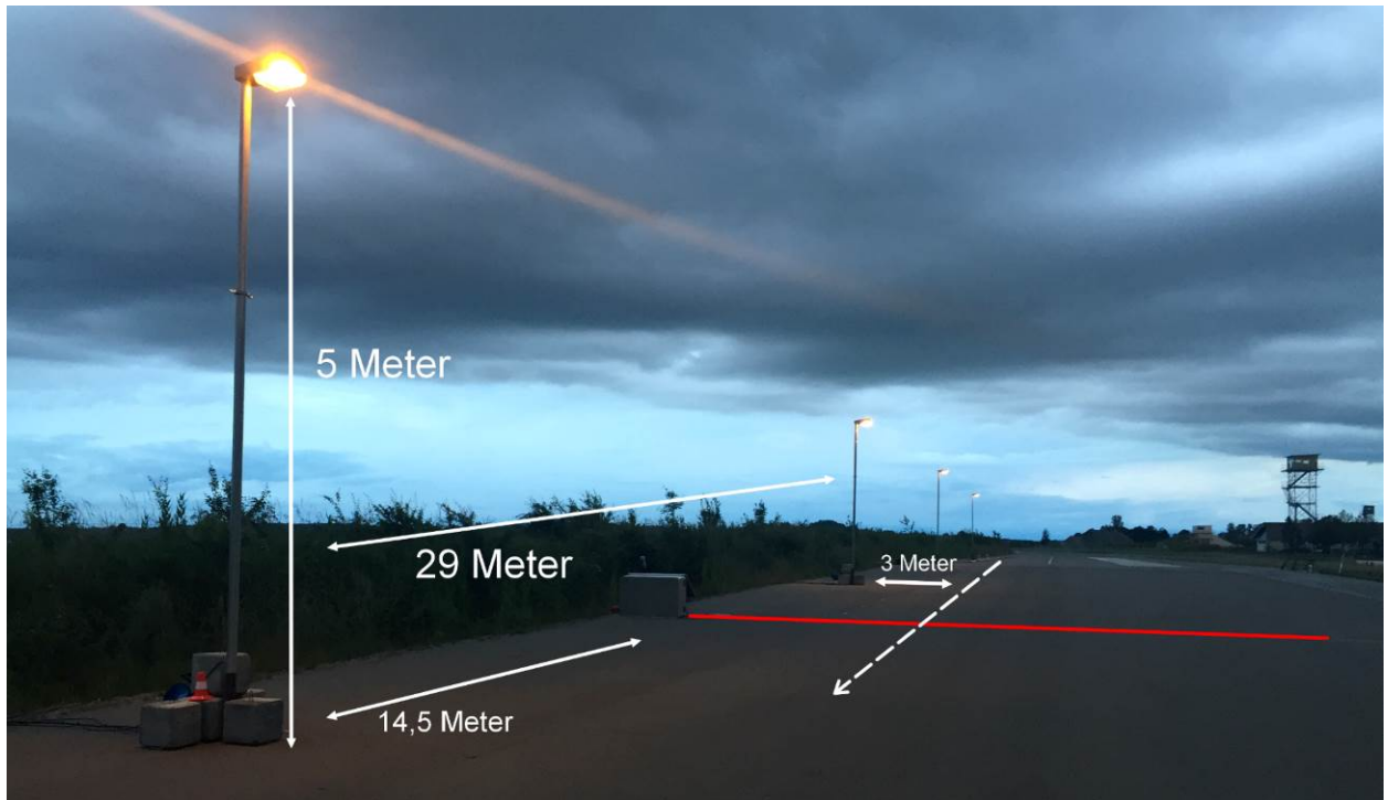
Abbildung 17: Positionierung der Straßenlaternen nach DIN13201
