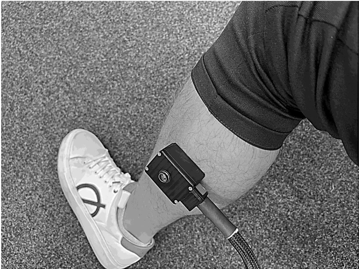
Abbildung 3: Peltier-Thermode am Bein für Hitzestimulation
