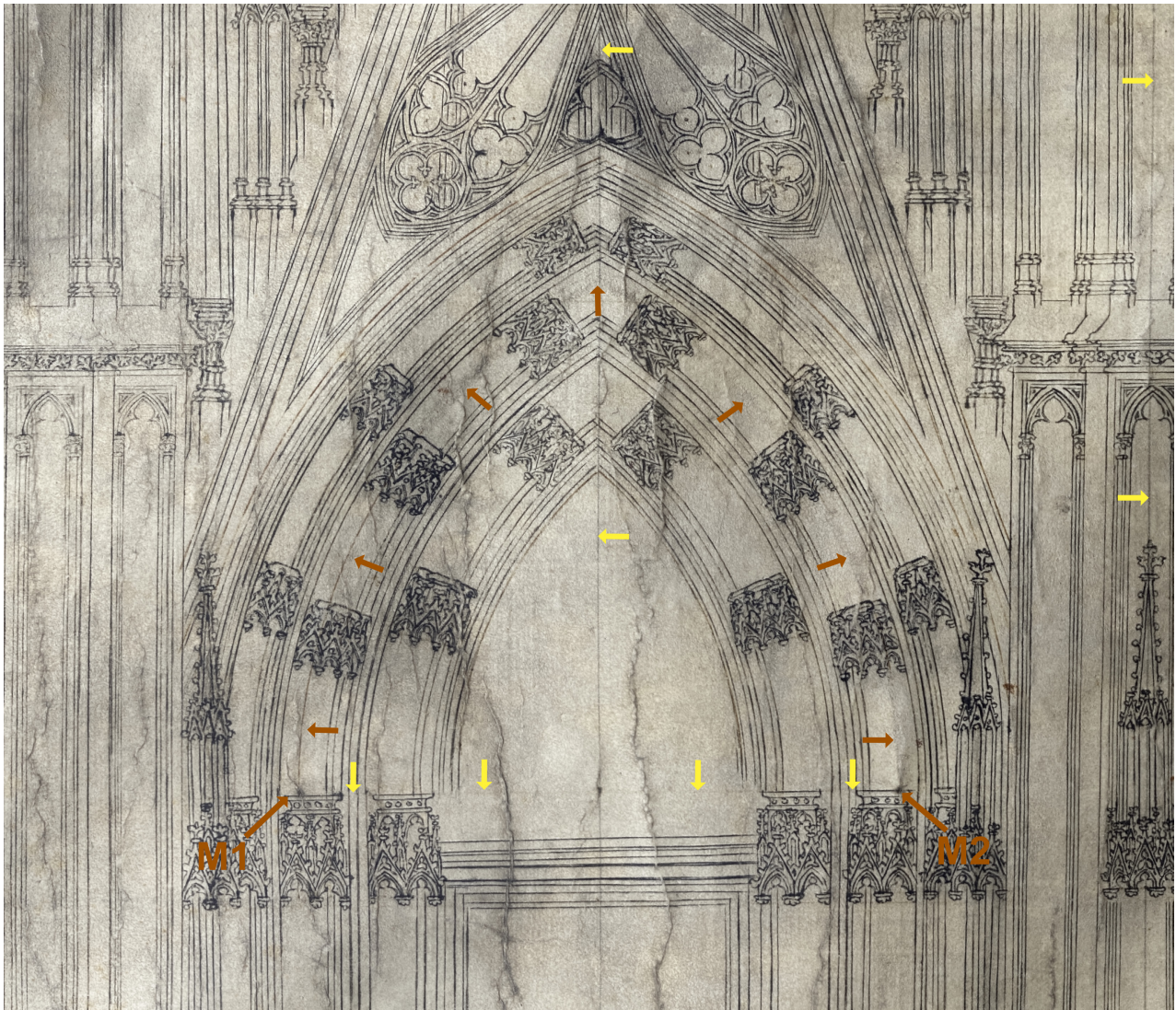
Abb. 18 Gelbe Pfeile: Blinddrillen, braune Pfeile: braune Tinte, M1/2: Zirkeleinschpunkte, Riss F, Blinddrillen und Tinte auf Pergament, um 1280, Köln, Dom, Johanneskapelle, Orthofoto des 3D- Modells
