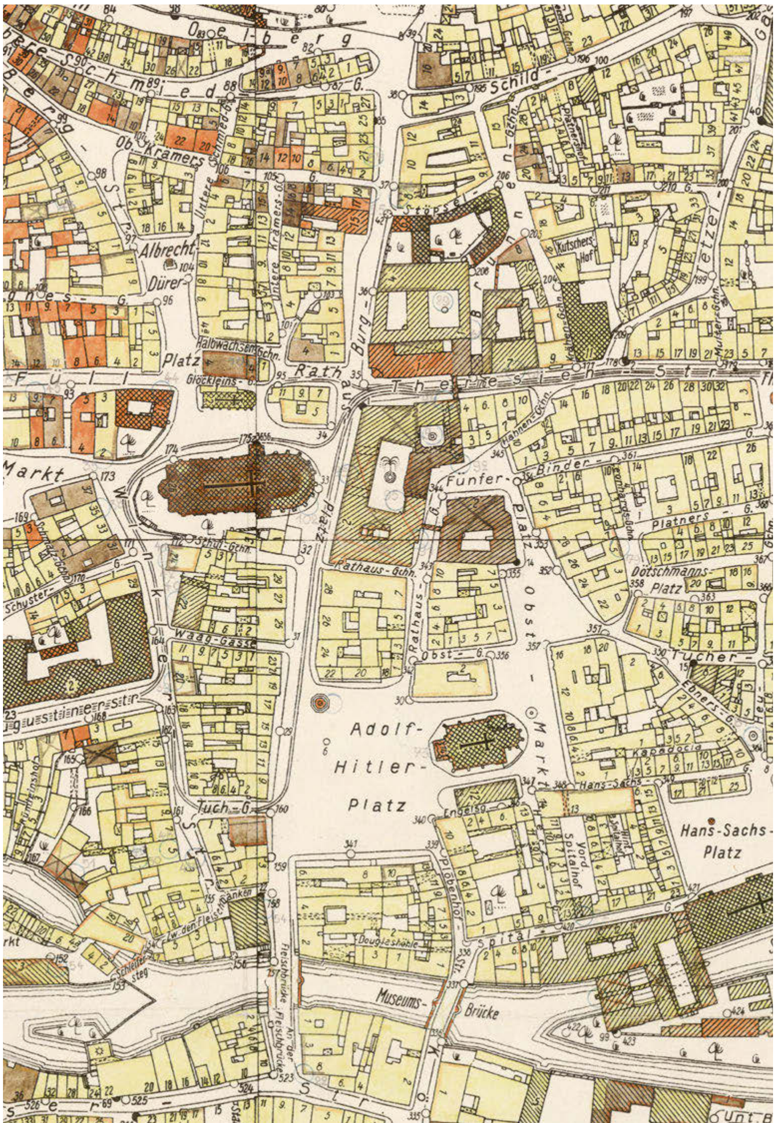
Abb. 1 Geprüfter Gesamtschadensplan für Nürnberg, 1945 (Kat. VI-12), Ausschnitt St. Sebald und Neues Rathaus, Auskreuzungen stehen für „noch vorhandene, teilweise bewohnte Untergeschosse“ zerstörter Gebäude
