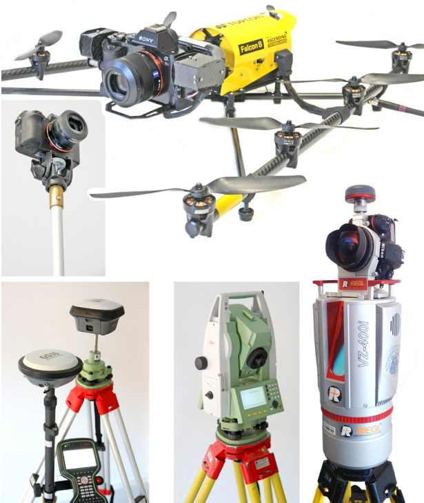
Abb. 4: Am KDWT vorgehaltene Geräte für verschiedene digitale Aufmaßtechniken, die dem jeweiligen Nutzungsszenario entsprechend angewendet und kombiniert werden können [Giese 2018].
