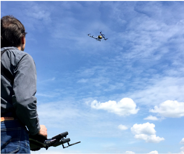
Abb. 1: Baudokumentation mit photogrammetrischen Verfahren durch UAV-Einsatz [Arera-Rütenik 2017].
