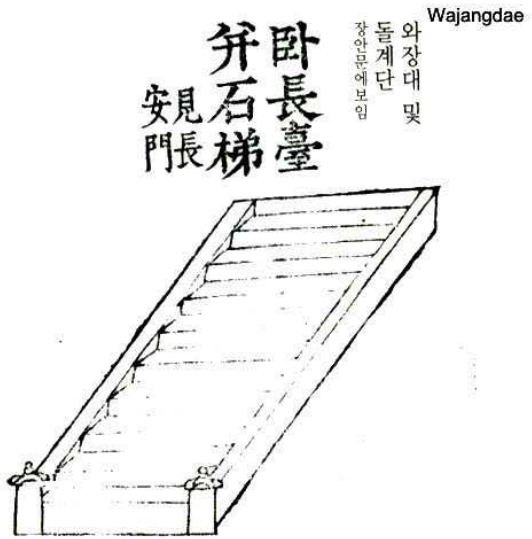
Abb. 40-3 Architekturdetails, Myeongmulgakdo : Bogenelemente, Quader und Treppenkonstruktion aus dem Hwaseong Seongyeok Uigwe um 1801
