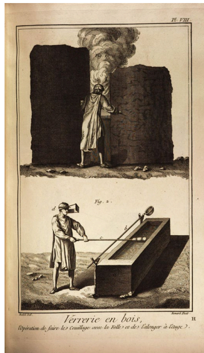
Tafel 12 Pl. VIII Fig. 1: Aufnehmen der heißen Glasmasse Fig. 2: Abkühlen des Kölbels über der Lösch- butt. Das zweifache Einschnüren des Kölbels wird nicht näher erklärt
