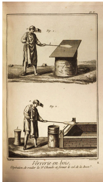
Tafel 14 Pl. X Fig. 1: Der Glasposten wird durch Rollen in die Länge gestreckt Fig. 2: Schränkung am Hals in Vorbereitung für das spätere Abtrennen der Pfeife
