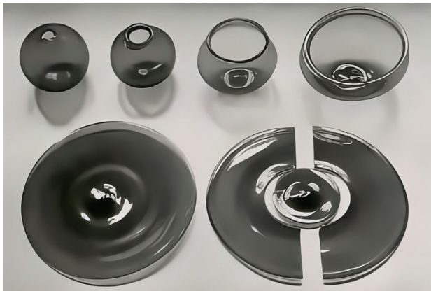
32 Fälschliche Darstellung der „Butzenscheibenherstellung in sechs Stufen“, wie sie in einigen Fachbüchern noch zu finden ist
