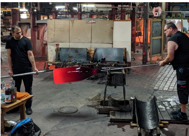
17 Zylinderblasverfahren ohne Schwenkgrube in der Glashütte Lamberts, Weitung der Öffnung mithilfe eines Paddels zu einem Halbzylinder
