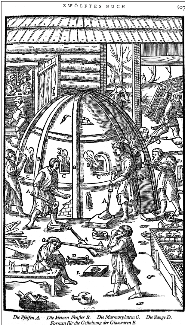
36a Darstellung der verschiedenen Arbeitsschritte der Hohlglasherstellung, wozu auch Butzenscheiben zählen
