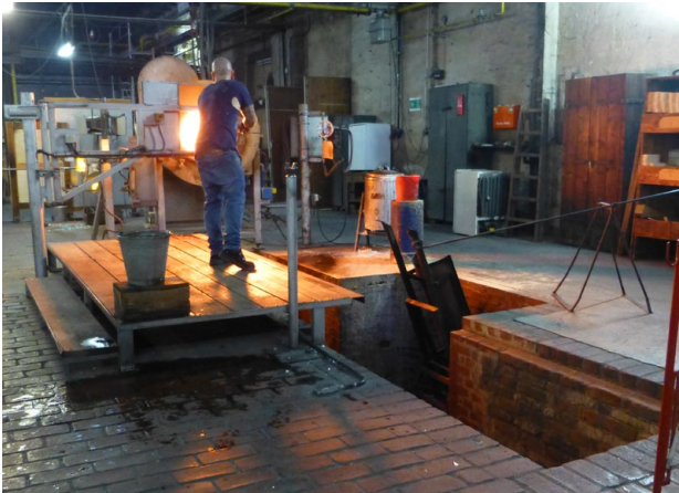
19 Zylinderblasverfahren mit Schwenkgrube in der Glashütte Lamberts. Der Glasmacher steht auf einem Podest über der Schwenkgrube
