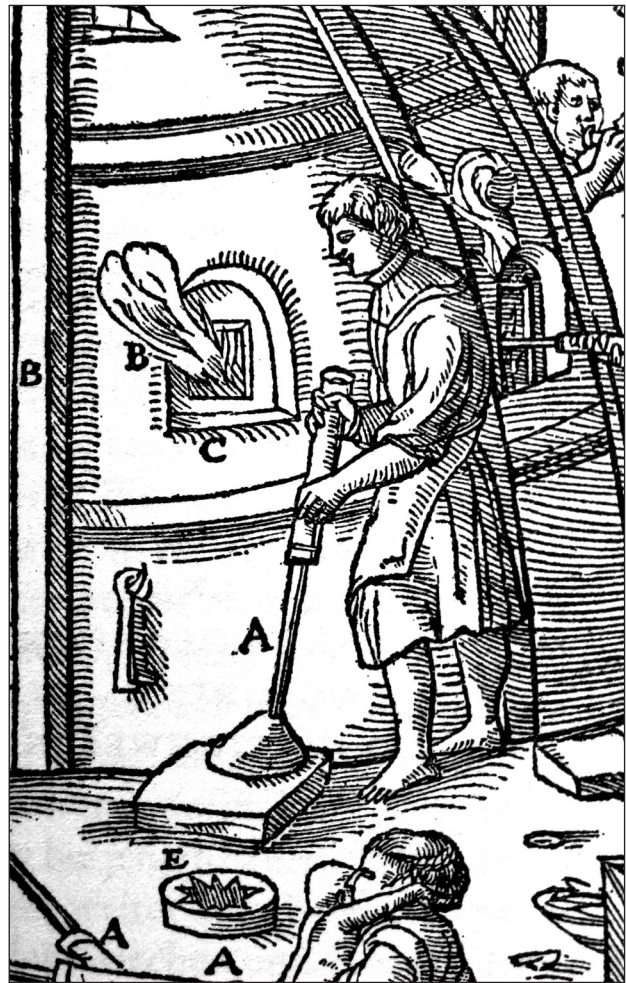
36b Die Detailaufnahme zeigt einen Glasmacher, der einen Glasposten auf eine flache Unterlage drückt
