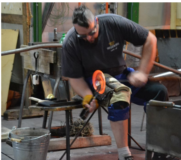
25 Butzenscheibenherstellung nach Lamberts. Die geöffnete Glaskugel wird mit einer Auftreibzange geweitet
