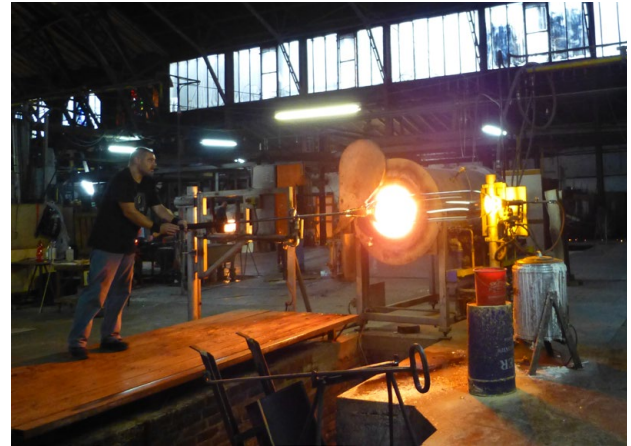
20 Zylinderblasverfahren in der Glashütte Lamberts mit Schwenkgrube. Der Boden des Zylinders wird an einem Gasbrenner (helle Flamme rechts im Bild) erweicht
