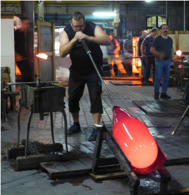
15 Zylinderblasverfahren ohne Schwenkgrube in der Glashütte Lamberts. Der Glasballon wird in einer Mulde zu einem Zylinder geblasen
