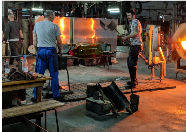
18a Zylinderblasverfahren ohne Schwenkgrube in der Glashütte Lamberts. Der Gehilfe übernimmt den Zylinder mit einer Metallklammer
