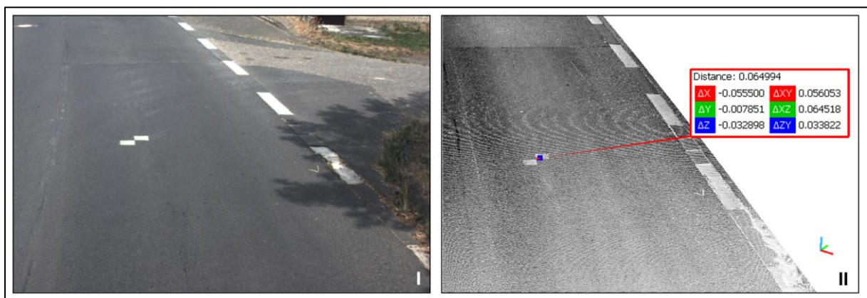
Abbildung 89: Passpunktmarkierung im Frontkamerabild (I) und PPS-Laserscan (II). Rechts ist in blau der mittels RTK-GNSS eingemessene Passpunkt zu sehen. Im Beispiel beträgt die 3D-Distanz zwischen Laserscan und Passpunkt ca. 6,5 cm.
