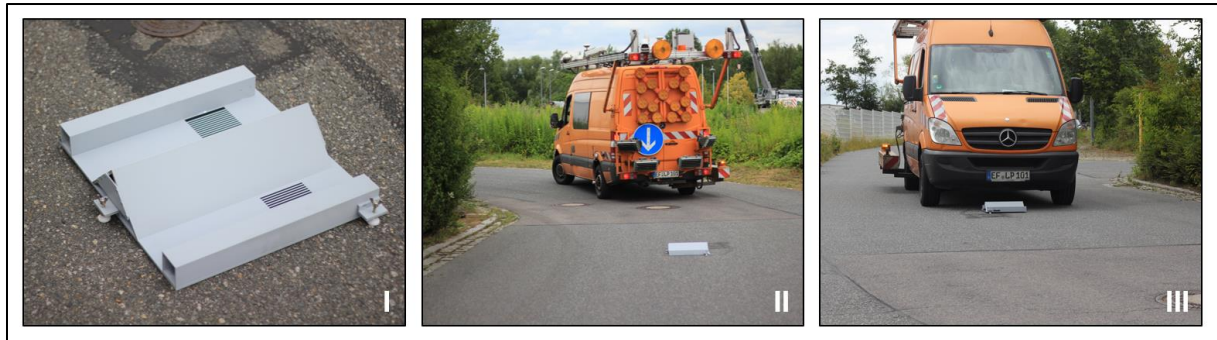
Abbildung 92: Aufnahme des Datensatzes zur Analyse der Präzision des mobilen Laserscanning Systems. Insgesamt wurden acht Laserscans des Prüfkörpers in einem Zeitraum von ca. 4 Minuten aufgezeichnet. Der Prüfkörper (I) wurde so positioniert, dass die geneigten Seiten des mittleren Elements in Fahrtrichtung ansteigen und abfallen sowie die Quaderelemente quer zur Fahrtrichtung verlaufen (II und III).
