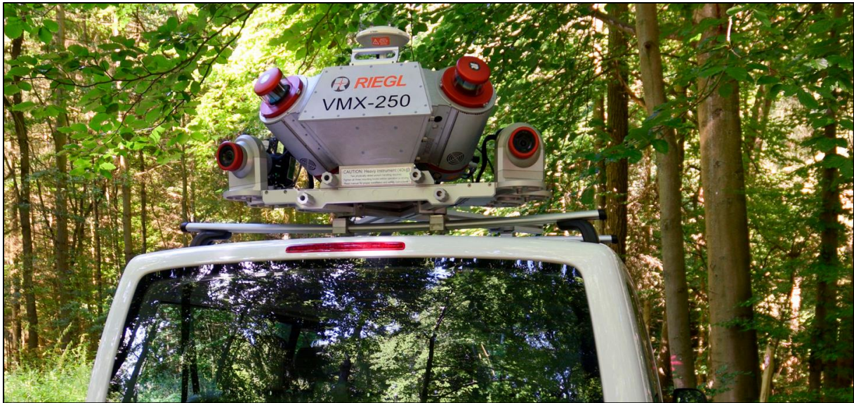
Abbildung 17: Beispiel für kompaktes und trägerfahrzeugunabhängiges Mobile-Mapping-System. Es umfasst neben einem inertialen Positionierungssystem zwei Laserscanner und sechs Kameras (BIENERT et al. 2018).
