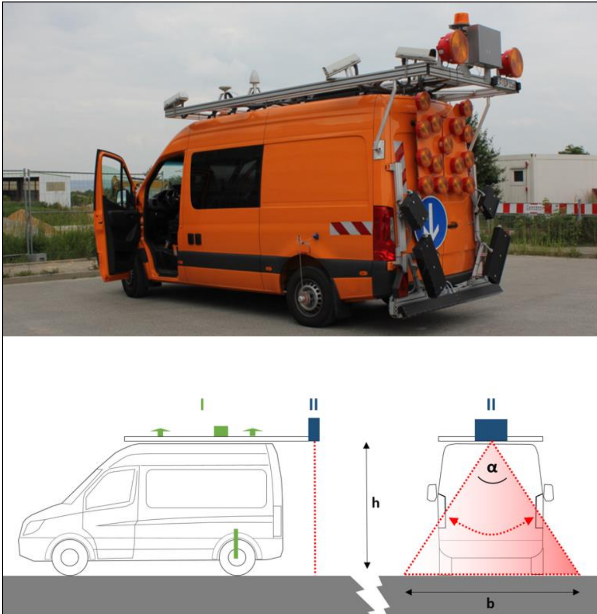
Abbildung 73: Das MLS-System I.R.I.S 16 der Firma Lehmann+Partner GmbH. Die Prinzipskizze (unten) zeigt den Messaufbau von der Seite und von hinten. Dargestellt sind die beiden für das Laserscanning relevanten Komponenten: inertiales Positionierungssystem (I) und Laserscanner (II). Die Montagehöhe h des Laserscanners beträgt ca. 3 m. Bei einem Sichtfeld von \alpha = 70^\circ kann ein ca. 4,2 m breites Profil b der Fahrbahnoberfläche erfasst werden.
