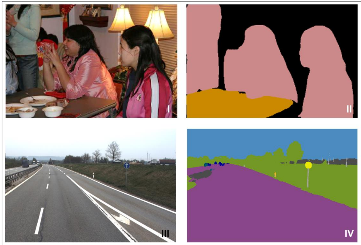
Abbildung 151: Segmentierungsergebnisse vortrainierter DeepLabv3+ Modelle. Die Teilabbildungen I und III zeigen je ein Eingabebild. Die Segmentierung oben rechts (II) wurde mit einem auf ImageNet- und COCO-Daten vortrainierten Modell erzeugt (nach CHEN et al. 2018b). Die Segmentierung unten rechts (IV) wurde mit einem auf CityScapes-Daten vortrainierten Modell erzeugt.
