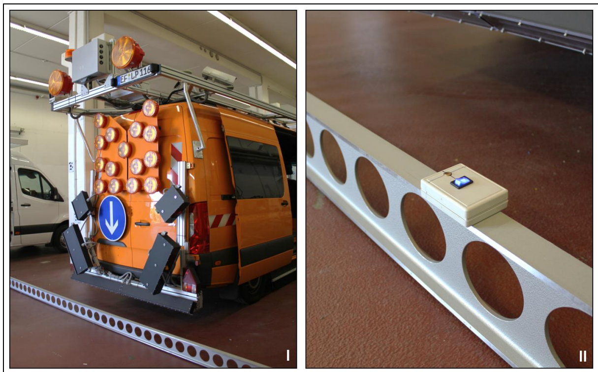
Abbildung 80: Kalibrierung des PPS mittels eines Stahl-Prüfkörpers (I). Die rechte Teilabbildung (II) zeigt auch den Infrarotsensor, mit dessen Hilfe der für das menschliche Auge unsichtbare Laser-Strahl detektiert und das Prüflineal in der Messlinie des PPS ausgerichtet werden kann.
