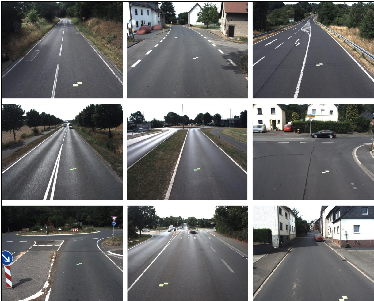
Abbildung 87: Beispielhafte Aufnahmen der Frontkamera des I.R.I.S-Messfahrzeugs während der Aufnahme des Datensatzes zur Bestimmung der absoluten Genauigkeit der Fahrbahnoberflächenscans.
