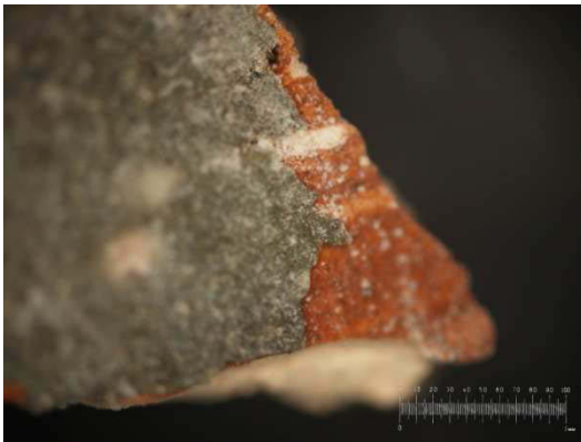
Abb.17.454: Mikroskopische Aufnahme eines Malschichtpartikels der rosafarbene Imprimitur (Auflicht). Es liegt eine bläulich-grünliche Schicht auf.
