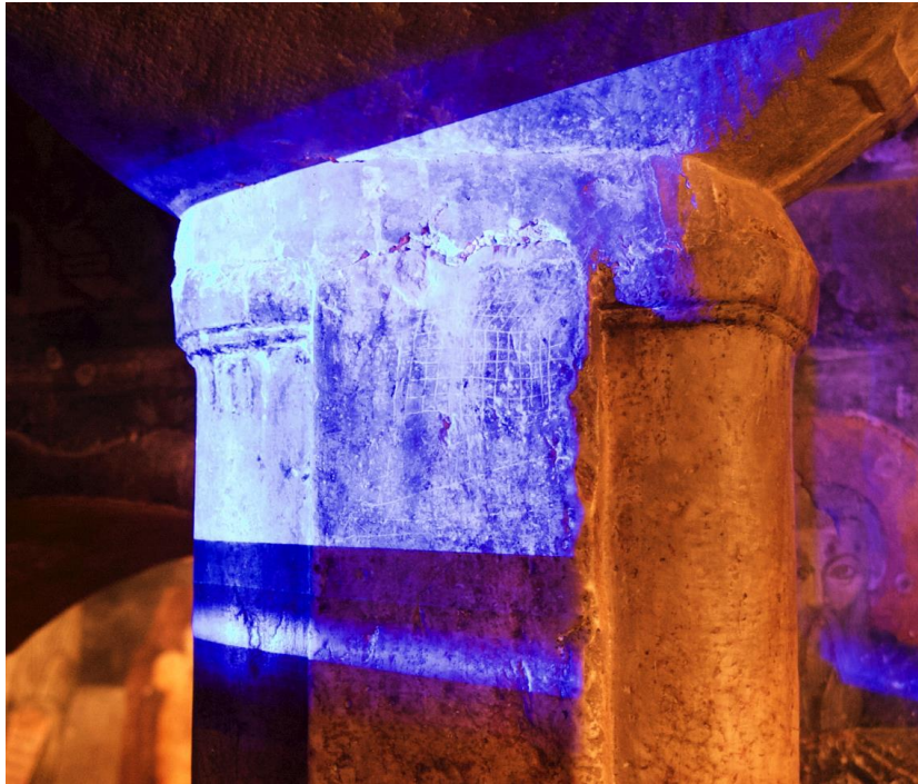
Abb. 9: Berührungsfreies Abtasten mit Meßlicht; rechte Säule, mit 'Netz'
