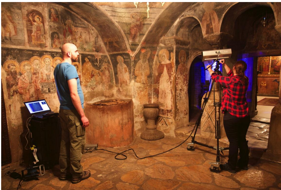
Abb. 10: Scanvorgang mit Scanner auf Stativ und angeschlossenem Laptop zur Steuerung und Datenübertragung
