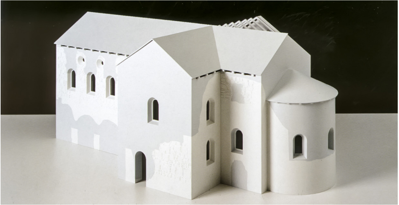
Abb. 5: Stiftskirche Walbeck, Rekonstruktionsmodell des Zustands um 964 (weiß: erhaltene Originalsubstanz); Der Schlüsselbefund dient auch der Rekonstruktion verlorener Fenster am Bau [Breitling / Cramer 2001].
